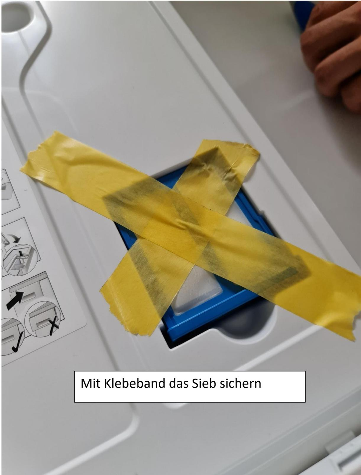
Mit Klebeband das Sieb sichern
